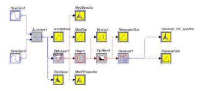
El diseño pretende mostrar los productos de distorsión armónica y la distorsión compuesta de segundo orden o CSO (composite second order) en el segmento de fibra de un sistema analógico HFC.
